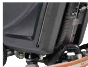
Indicador do nível de água com volume visível no depósito.
