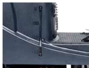
Indicador do nível de água visível no depósito.
